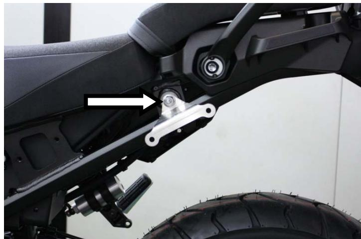
**IT** · Avvitare la telaio la staffa di sostegno terminale
