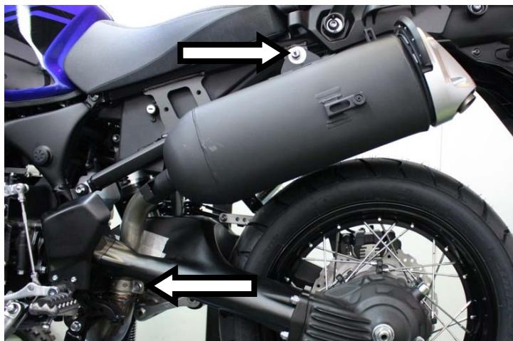
**IT** · Allentare la fascetta, svitare le vite di fissaggio e rimuovere il terminale originale
