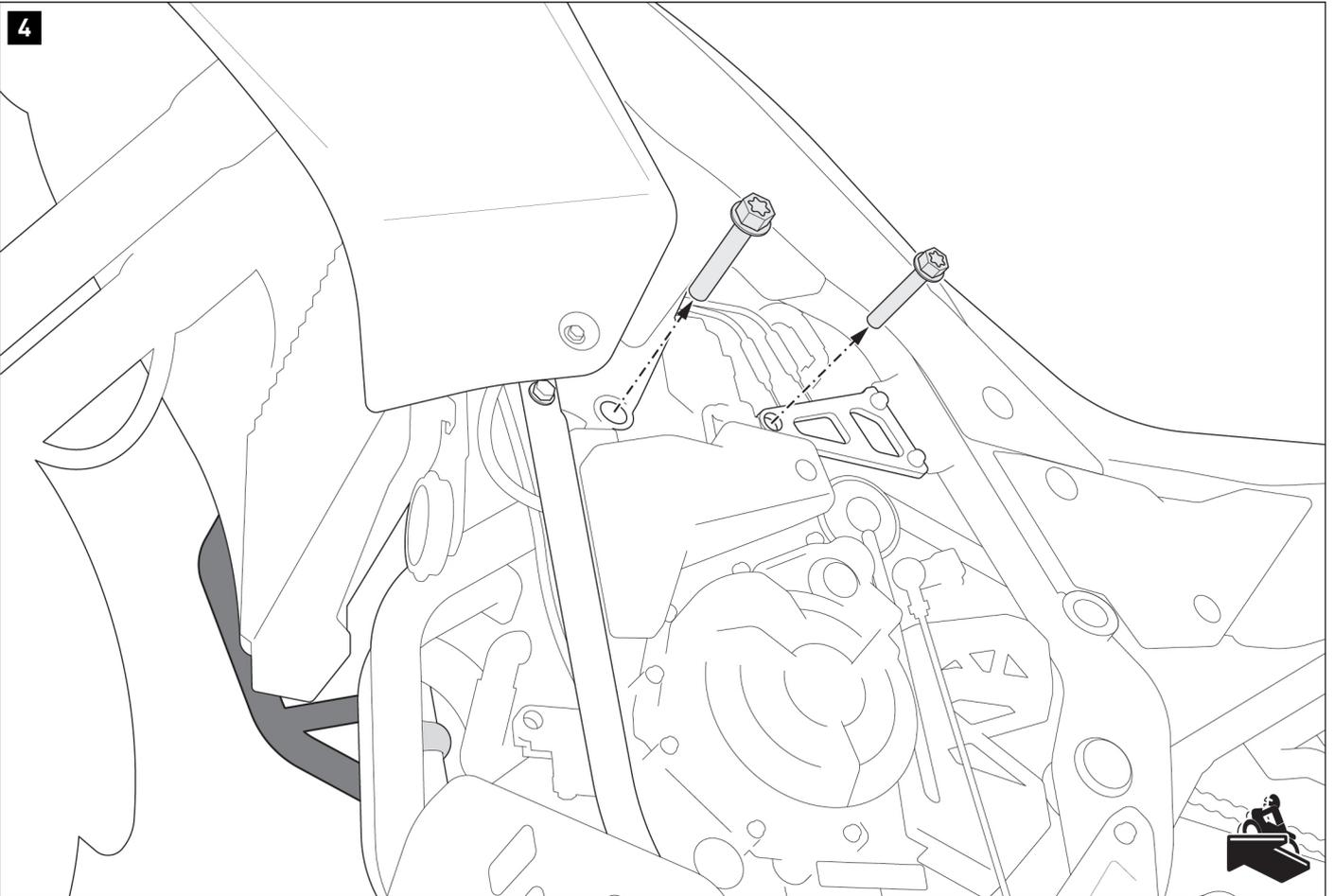
Entfernen Sie die beiden gezeigten Schrauben auf der linken Fahrzeugseite.
