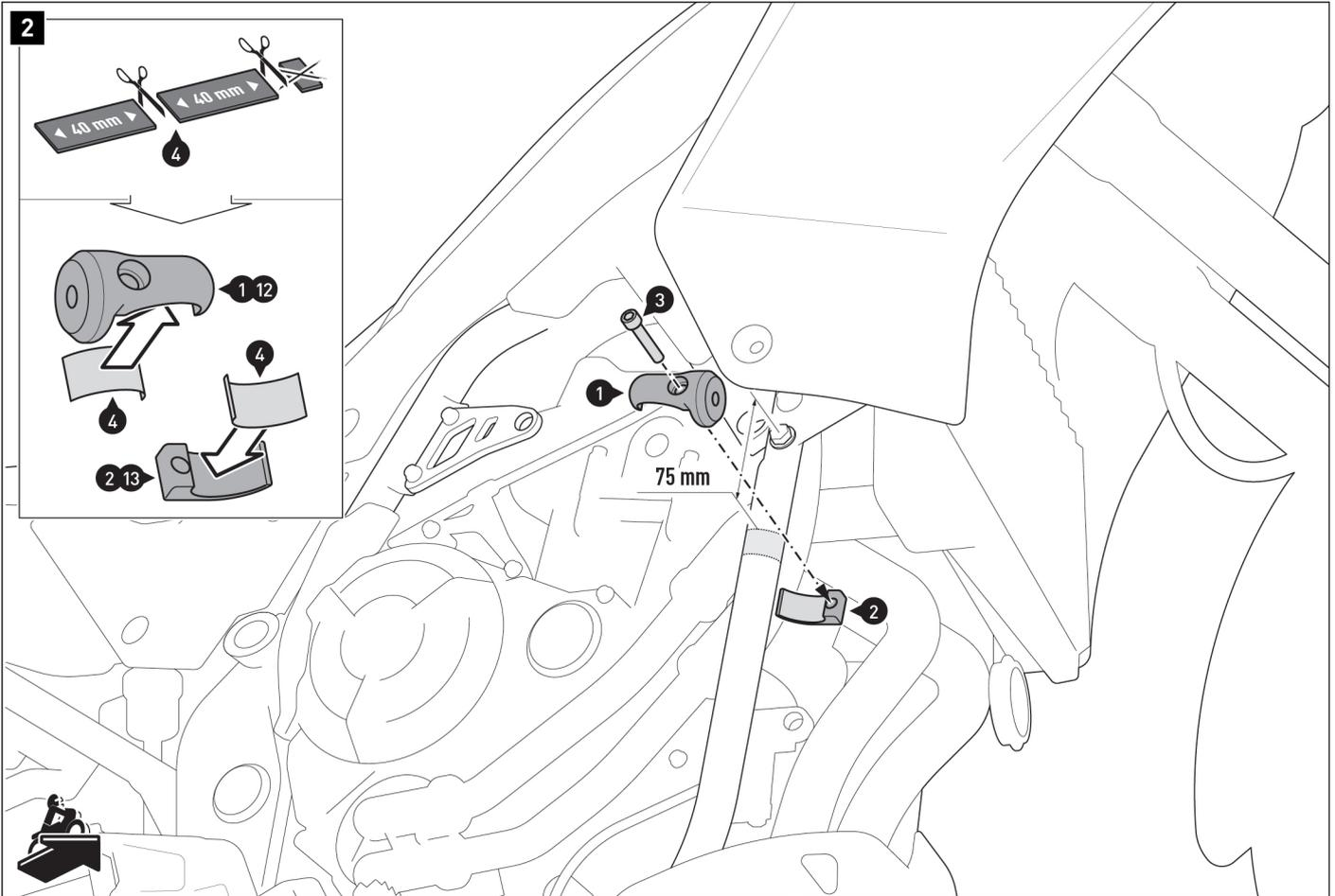
Schneiden Sie die beiden Gummistreifen (4) in je zwei 40-mm-Stücke (der Rest entfällt).
