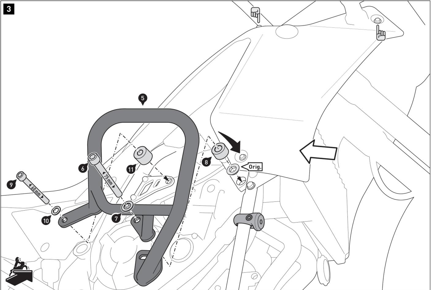
Verschrauben Sie den rechten Sturzbügel (5) mit der original Buchse (Orig.) am Fahrzeug.
