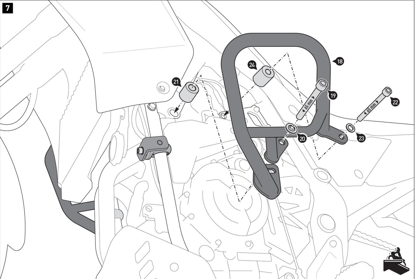
Verschrauben Sie den linken Sturzbügel (18) am Fahrzeug.
