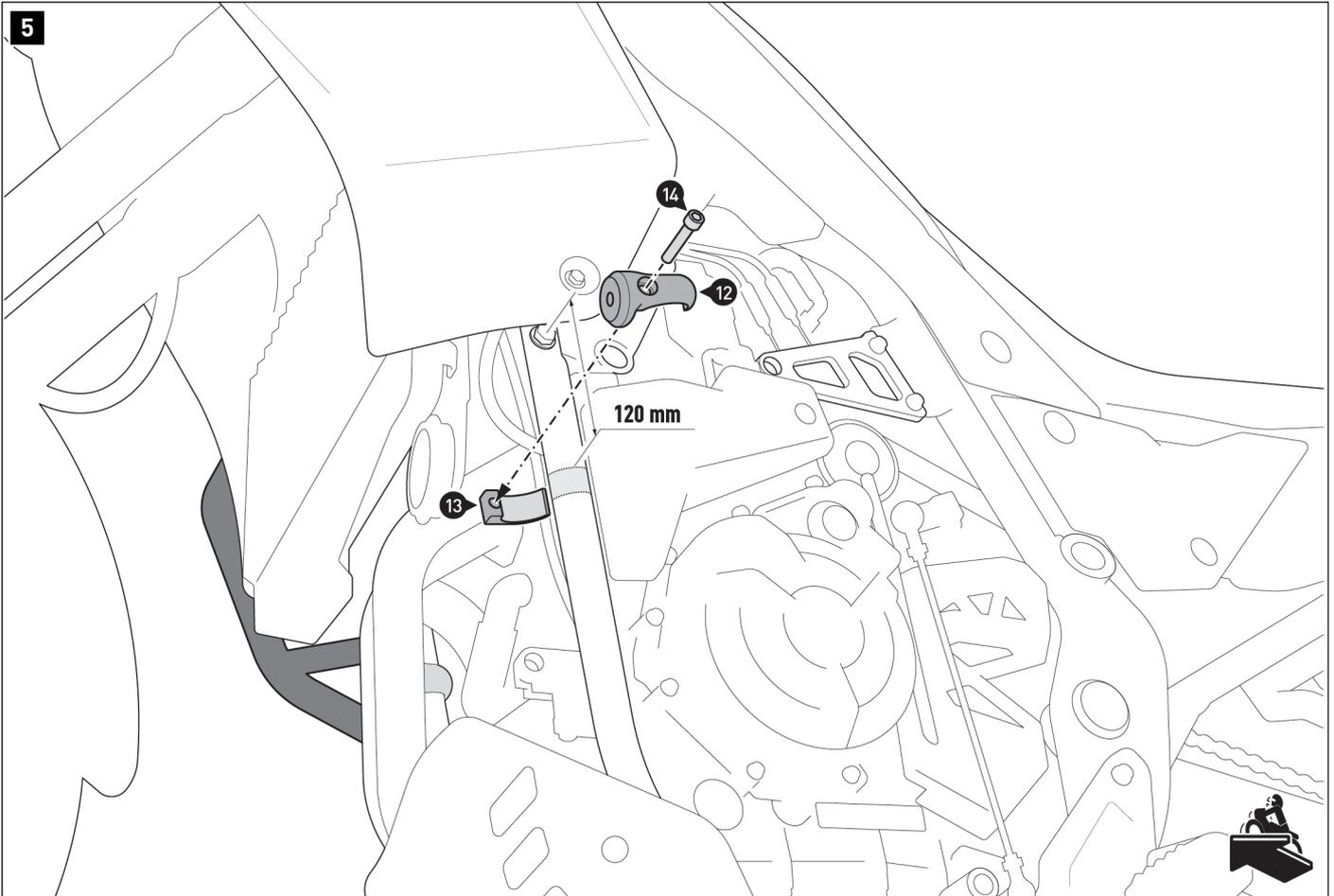
Verschrauben Sie die Klemme [12] und [13] am Fahrzeugrahmen.
